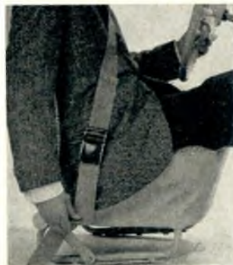
● Förkorta bältet. Dra bara rakt nedåt i den fritt hängande delen av bältet.
