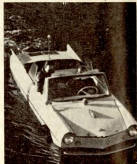
Bil på böljan blå. Men att försöka använda blinker vid kursändring skapar undran bland navigatörer. Amphicar heter amfibien, som är tysk och har en Triumph-motor.
