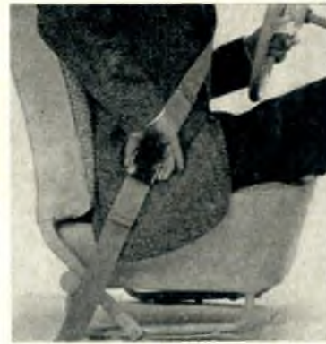
● Förläng bältet. Fatta låsmekanismens spärr med tummen och pekfingeret och för hela låset uppåt.
