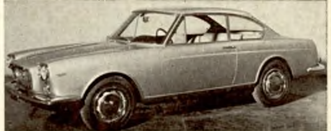
Lancia finns åter att köpa i Sverige — och det gäller också den vackra coupén på Flaviachassie. Med en vattenkyld boxermotor fram och framhjulsdrift vänder sig modellen till det exklusiva fåtalet bilentusiaster.
