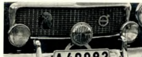
Ett propert montage av extraljus och starktonshorn.
